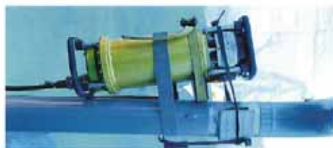
配管の放射線検査
